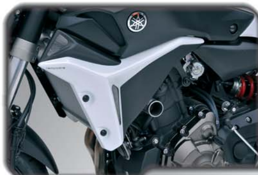
Saute-vent double galbe hauteur : 39 cm Nose screen double shape height : 39 cm
